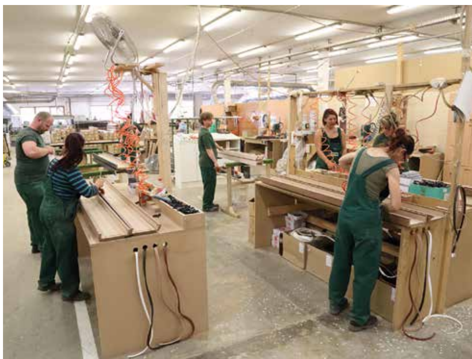
Pánt- és gumiprofil-elhelyezés valamint minőség-ellenőrzés
