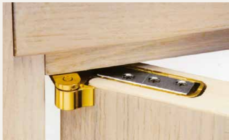
Egy jó példa a falc nélküli ajtóvasalatra az SFS Cab-R pánt, amely akár 180°-os nyitási szöveget is megenged és az ajtólap-beállításokat akár beépített állapotban elvégezhetjük egyszerűen, egy imbuszkulcs segítségével (faipar.hu)
