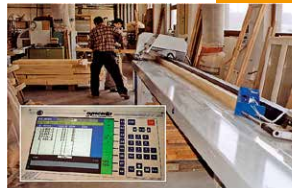
5. kép: páros-végprofilozógépnél a szabászatra nincs szükség
