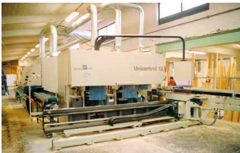
1. kép: ablakgyártó központ csapozó egysége
