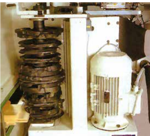
2. kép: szerszámtorony csapozó szerszámai
